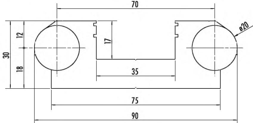
Система AV отличается от системы AD в способе крепления стальных реек, и габаритами проема OхР. Разработка специального профиля корпуса сделала возможным устраниить крепежные винты, а стальные рейки закрепляются прокаткой, через деформации верхней части профиля. В направляющих V20, также используется специальный двухкомпонентный клей, который гарантирует, что стальные рейки будут надежно удерживаться под тяжелыми грузами.
