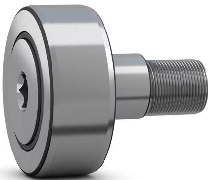
NUKRE 52 A Опорный ролик с цапфой на основе роликоподшипника с эксцентриковым кольцом, встроенным уплотнением и элементами для повторного смазывания
