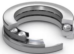
Одинарные упорные шарикоподшипники со сферическим свободным кольцом предназначены для восприятия осевых нагрузок, действующих в одном направлении. Данные подшипники не должны подвергаться радиальному нагружению. Многие компоненты взаимозаменяемые. Тугие кольца имеют шлифованное отверстие для посадки с натягом. Сферические свободные кольца выдерживают первоначальное смещение при правильной конфигурации со сферическим подкладным кольцом или компонентом оборудования со сферической поверхностью.
