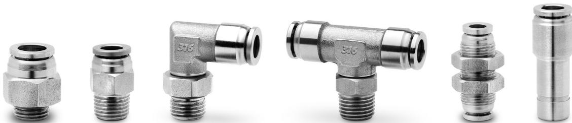
**Фитинги Серии X6000 из нержавеющей стали пригодны для использования в химически агрессивных средах. Цанга обеспечивает надежное соединение трубопровода.**
