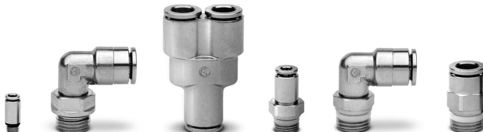
**Быстроразъемные фитинги серии 6000 разработаны со специальной цангой, обеспечивающей равномерное уплотнение всей поверхности пластиковых трубок, тем самым обеспечивая высокую надежность и длительный срок эксплуатации, позволяя много раз присоединять и отсоединять трубы. Широкая номенклатура данных фитингов включает различные типы присоединительных резьб: метрическая, BSP и BSPT.**
